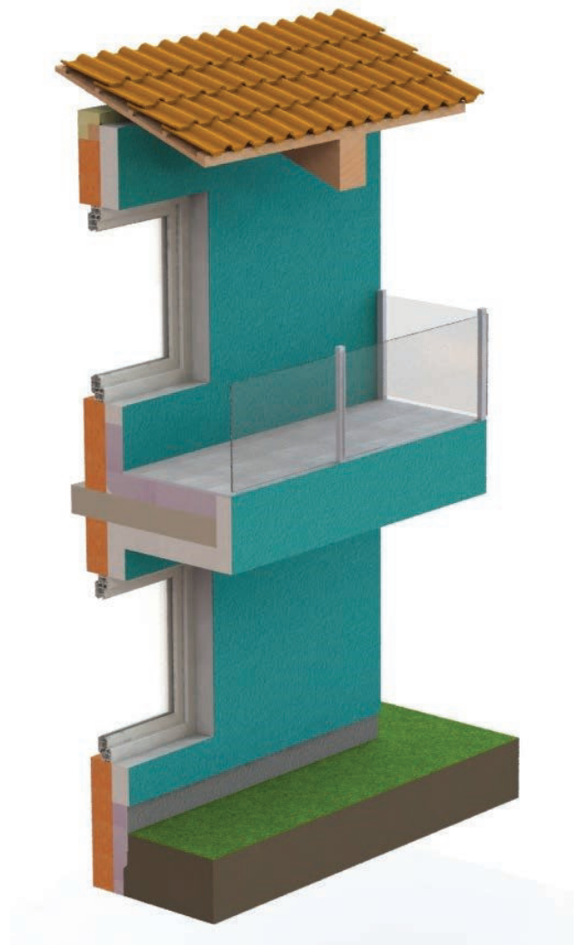
Abbildung 1.1: Schematischer Schnitt durch eine Fassade mit einem WDVS
